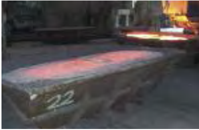
Auskühlendes Rohsilicium kurz nach dem Abstich bei über 1.600 °C
