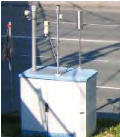
Bild links: Verkehrsmessstation: Auf dem Dach befinden sich die Probenahmegeräte für Feinstaub und gasförmige Luftschadstoffe.
