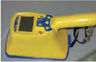
Kontamat mit Szintillations- und Dosisleistungssonde
