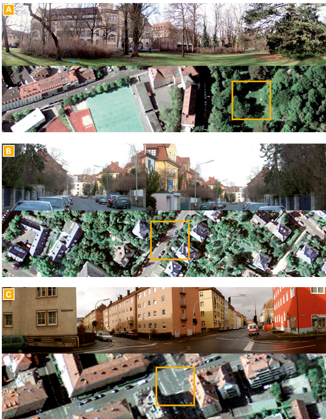
Abb. 1: Erscheinungsbild einer unversiegelten (A), einer teilversiegelten (B) und einer vollständig überbauten (C) Fläche
