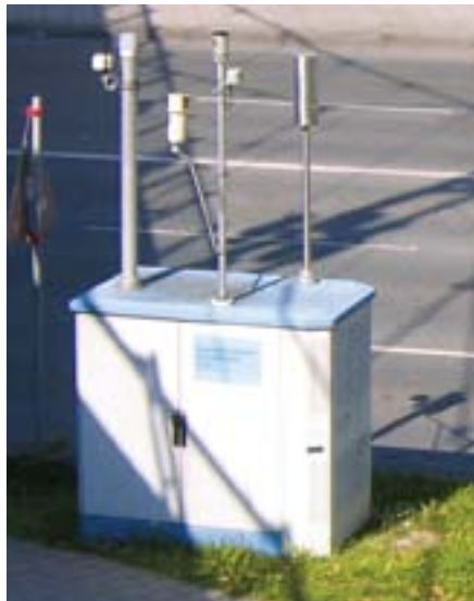
Verkehrsmessstation: Auf dem Dach befinden sich die Probenahmevorrichtungen für Feinstaub und gasförmige Luftschadstoffe.
