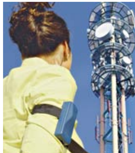
Das Mobilfunkdosimeter wird am Oberarm getragen und registriert die Strahlung nahezu aus der gesamten Umgebung der Person.
