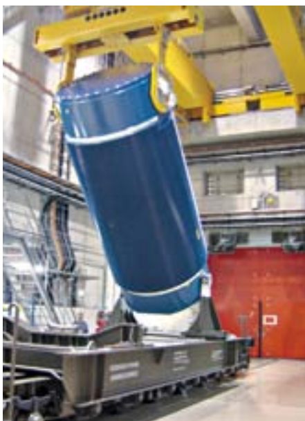
Aufrichten des CASTOR-Behälters im Verladebereich.
