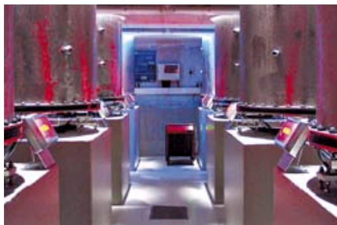
Lysimeter-Anlage zur Untersuchung von Boden-Sickerwasser
