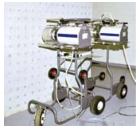
In-Situ-Detektoren vor einem Kalibrierphantom für Gebäudestrukturmessungen, das 16 x 16 Röhren für Punktquellen bzw. Betonstopfen aufweist.
