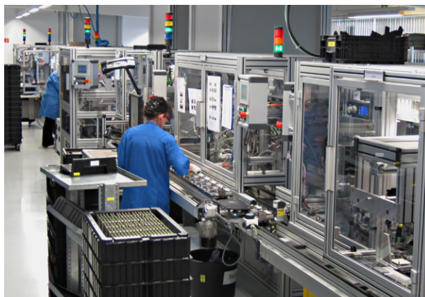
Montage- und Prüfanlage für Radarsensoren
