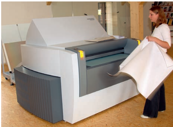
Eine Mitarbeiterin bedient die prozesslose Belichtungsanlage
