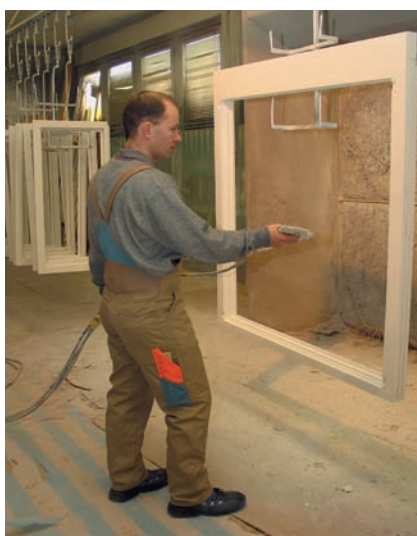
Herr Ettinger lackiert die Fenster mit lösemittel-freiem Lack auf Wasserbasis
