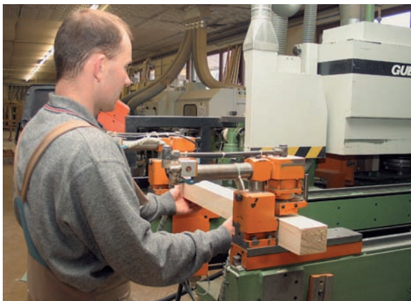
Zuschnitt von Fensterholz, im Hintergrund die Absauganlage
