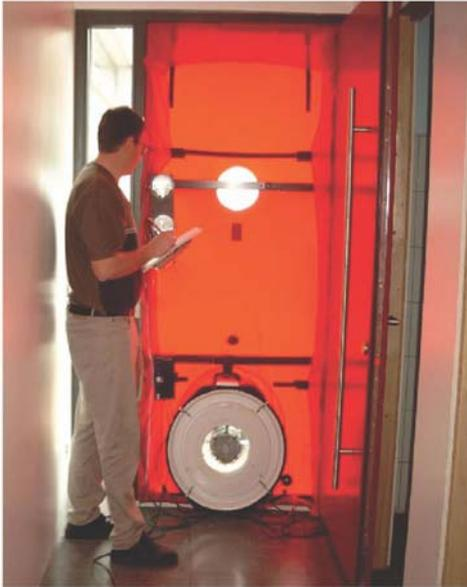
„Blower-door-Test“ zur Überprüfung der Luftdichtheit eines Gebäudes
