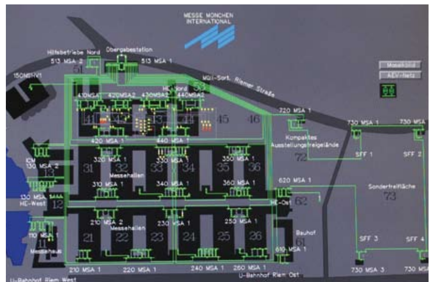
Die Software zur leistungsabhängigen Transformatorenschaltung
