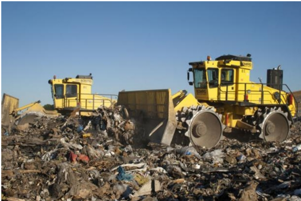
Abb. 1: Müllleinbau mit Kompaktoren auf der Deponie Außernzell (vor 1998)
