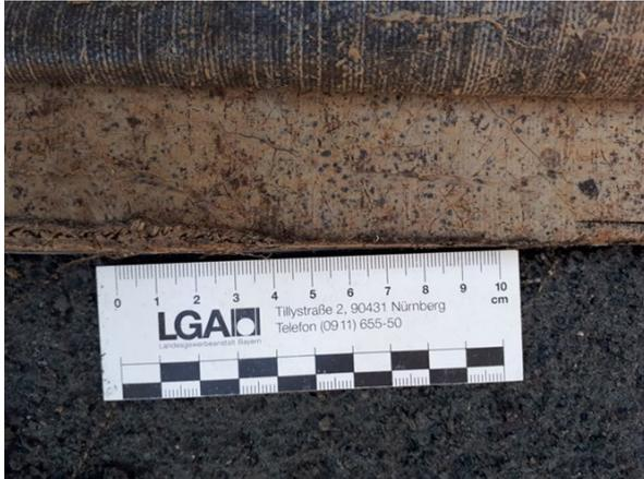
Abb. 2-3: Aggregatbildung in einer Bentonitmatte (Deckgewebe entfernt)
