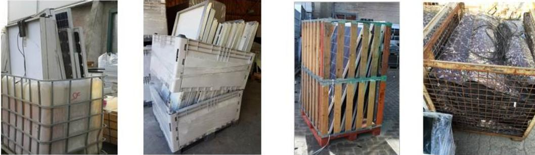
Bilder 11 – 14: Erfassung von PV-Modulen in Boxen an kommunalen Übergabestellen
