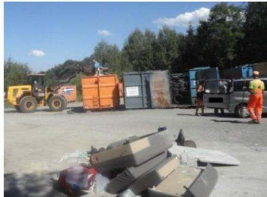
Verkehr von schweren Fahrzeugen bei laufendem Betrieb, ohne Absperrung des Bereiches
