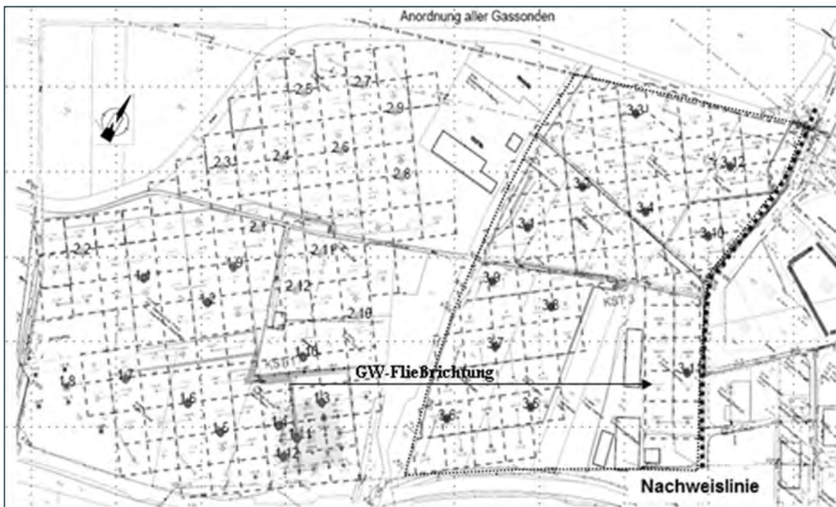
Abb. 9: Grundriss der Deponie Pill mit den 216 Belüftungsfeldern und den 35 Bodenluftmessstellen (3.1 bis 3.12 im rechten Feld). An der Nachweislinie erfolgt die Erfolgskontrolle der Belüftungsmaßnahme.
