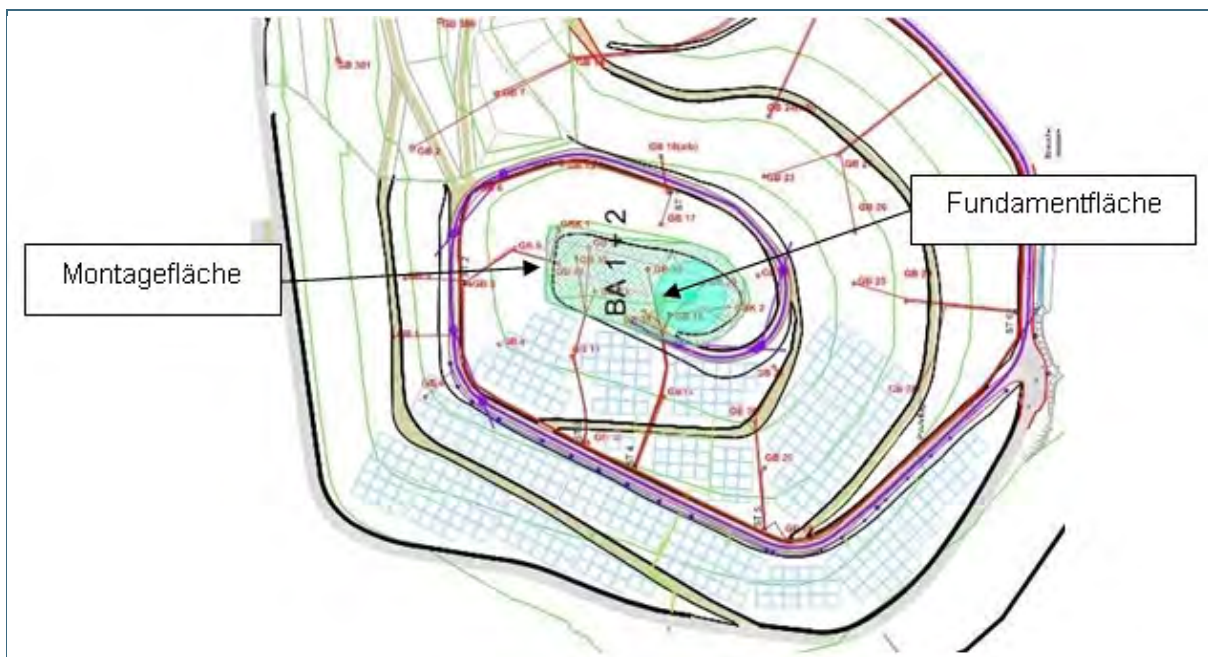
Abb. 5: Lageplan Windenergieanlage auf der Kuppe des BA 1/2
