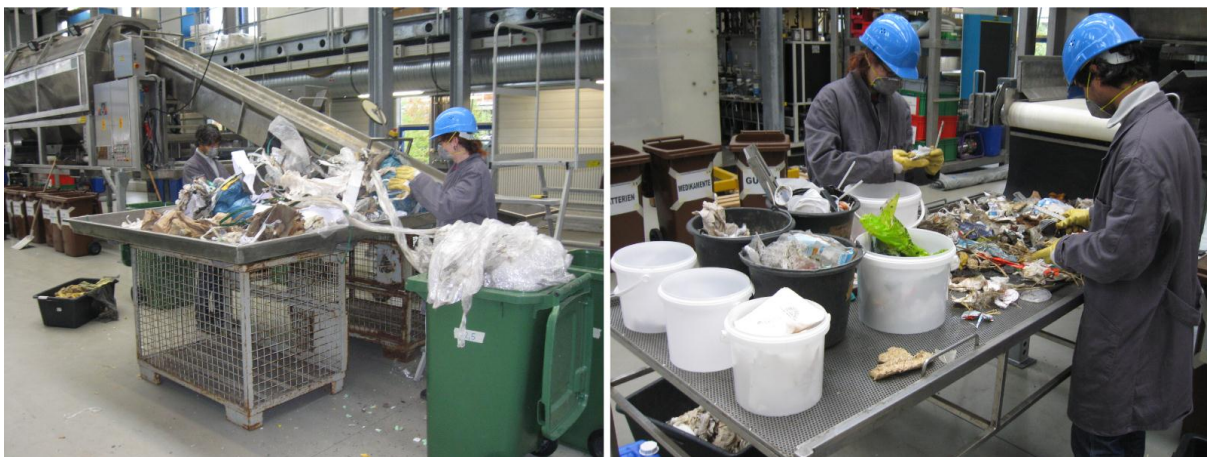
Abb. 14: Entnahme großstückiger Bestandteile (Grobfraction) vor der Aufgabe auf das Förderband (links) sowie Sortierung der Grobfraction auf dem Sortiertisch (rechts).
