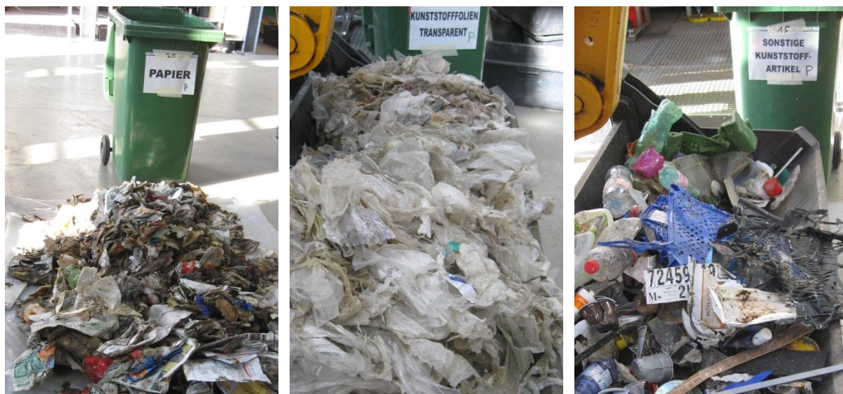
Abb. 17: Aus gemischten Gewerbeabfällen abgetrennte Fraktionen: Papier/Pappe/Kartonage (links), transparente Kunststofffolien (Mitte), Sonstige Kunststoffe (rechts).
