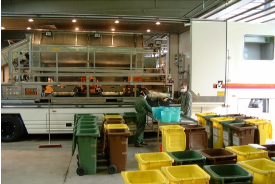
Abb. 7: Mobile Abfallsortier- anlage des LfU
