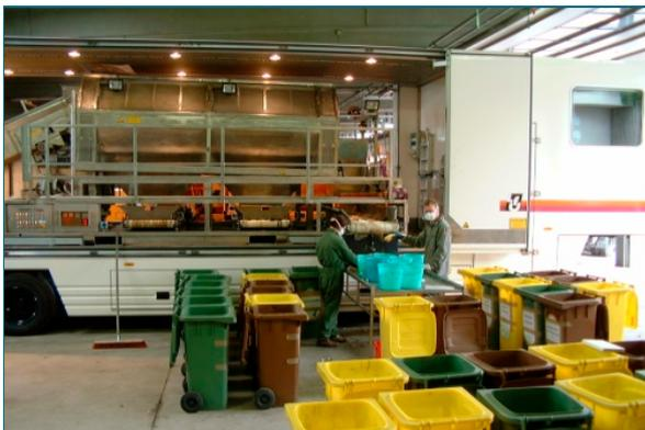
Abb. 3: Mobile Abfallsortieranlage
