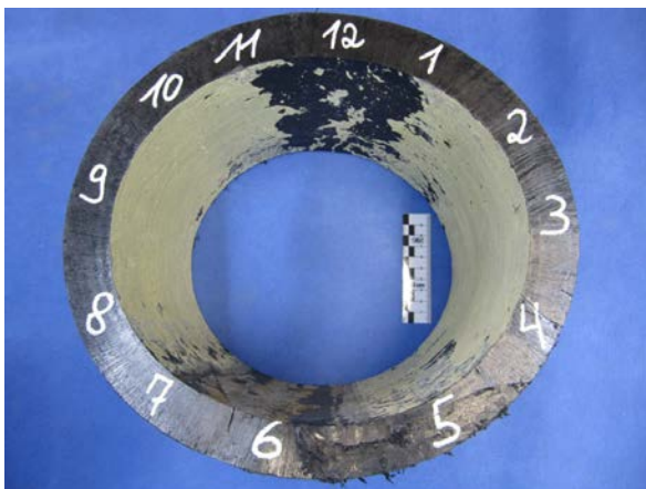
Abb. 4: Material A (Vollwandrohr, d_A = 280 mm, ca. 20 Jahre alt); Riss in der Rohrinneenseite im Sohlbereich
