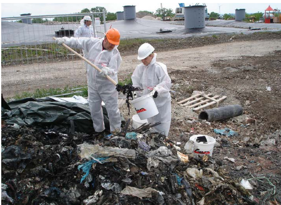
Abb. 5: Beprobung der ausgehobenen Abfallcharge
