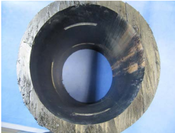
Abb. 5: Material B (geschlitztes Rohr, d_A = 250 mm, 20 bis 25 Jahre alt)
