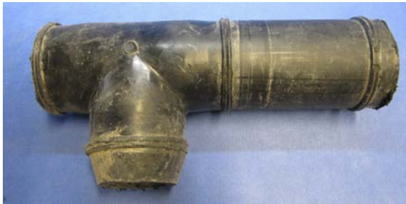
Abb. 6: Material C (Vollwandrohr mit T-Stück, d_A = 90 mm, ca. 15 Jahre alt)
