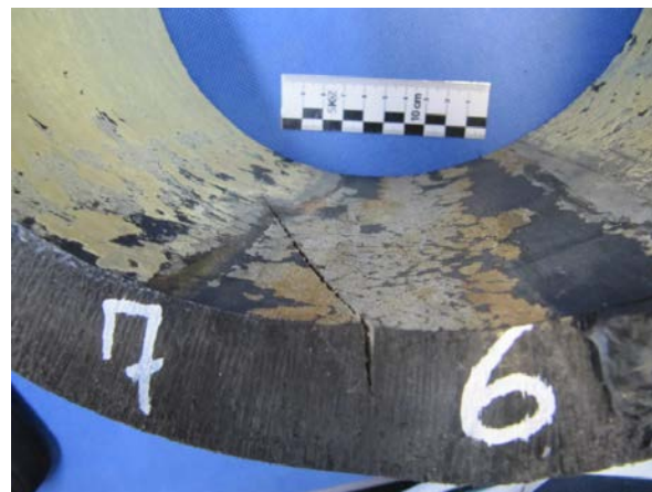
Abb. 4: Material A (Vollwandrohr, d_A = 280 mm, ca. 20 Jahre alt); Riss in der Rohrinneenseite im Sohlbereich
