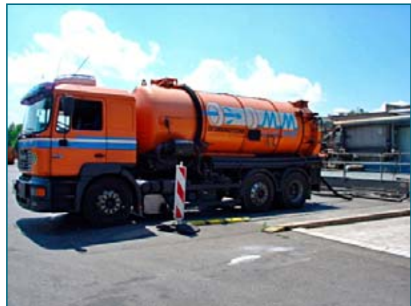
Abb. 4: GSB Baar-Ebenhausen – Anlieferung von Emulsionen mit Saugwagen
