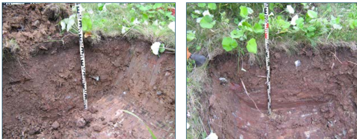
Abb. 7: Fotodokumentation: bodenkundliche Schürfe in der Rekultivierungsschicht, Deponie Bayreuth-Heinersgrund
