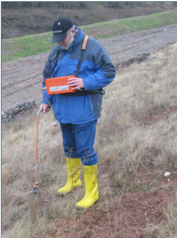
Abb. 1: FID- Messung an der Deponieoberfläche
