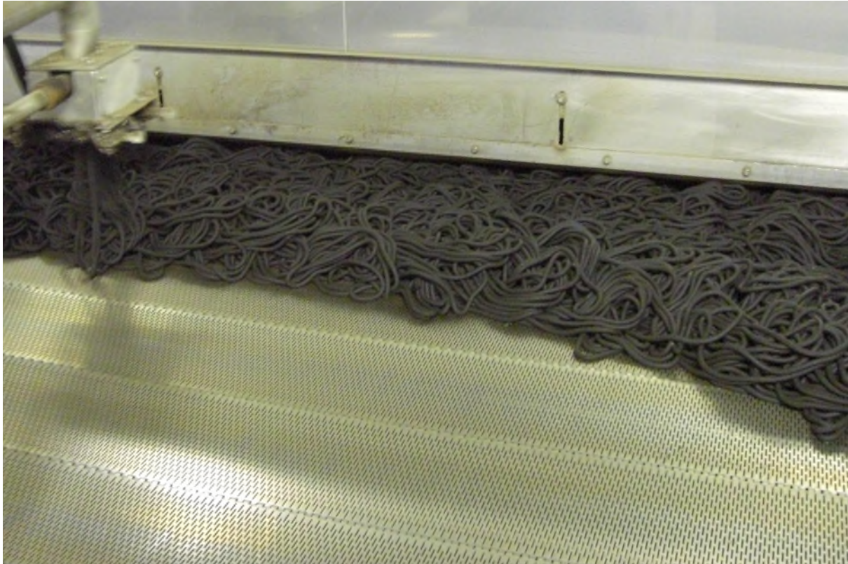
Abb. 7: Trocknerband mit Klärschlamm-Presslingen
