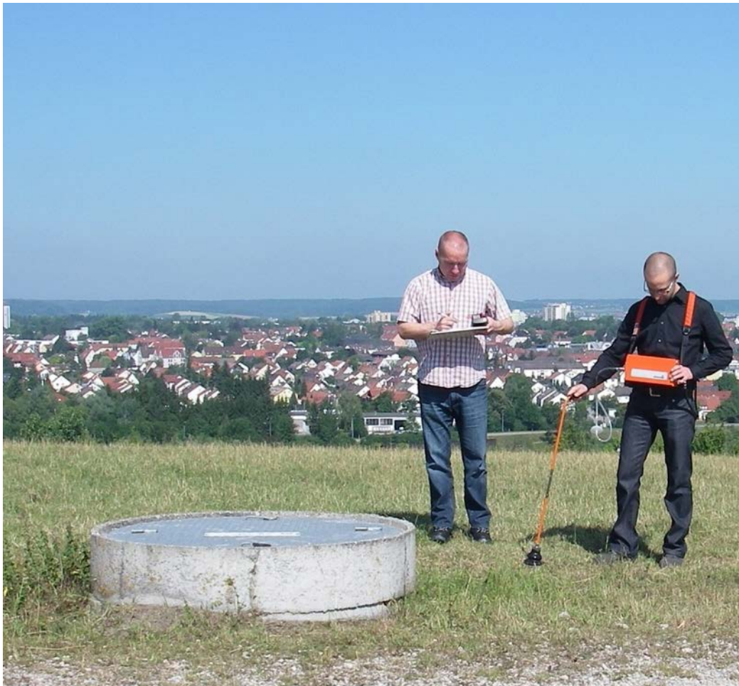
Abb. 1: FID-Messung auf einer Deponie
