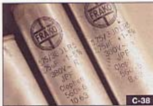
PCB-haltige Kondensatoren mit Kennzeichnung Clophen
