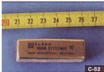
Quecksilberschalter mit Firmenbezeichnung und Positionspfeil
