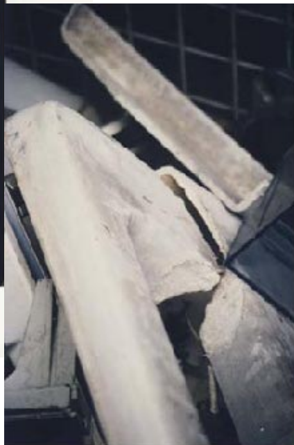
Asbesthaltige Bauteile, Fotos ZME
