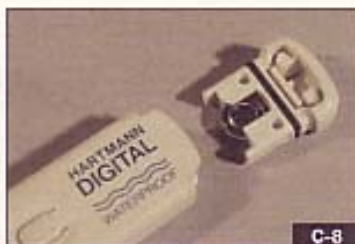
Knopfzelle in Fieberthermometer C-8
