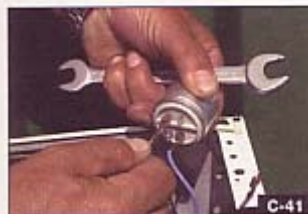
Abziehen der Kabeln vom Kondensator
