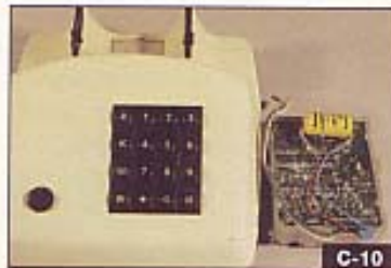
Pufferbatterie auf Leiterplatte von Telefon
