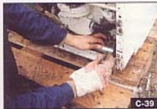
Ausschrauben eines Kondensators aus der Befestigung
