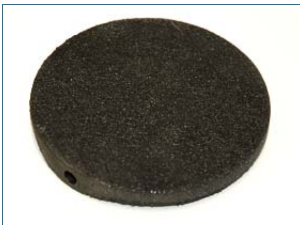
Abb. 8: In den Dialyseexperimenten verwendete Graphitelektroden (Anode, Kathode).
