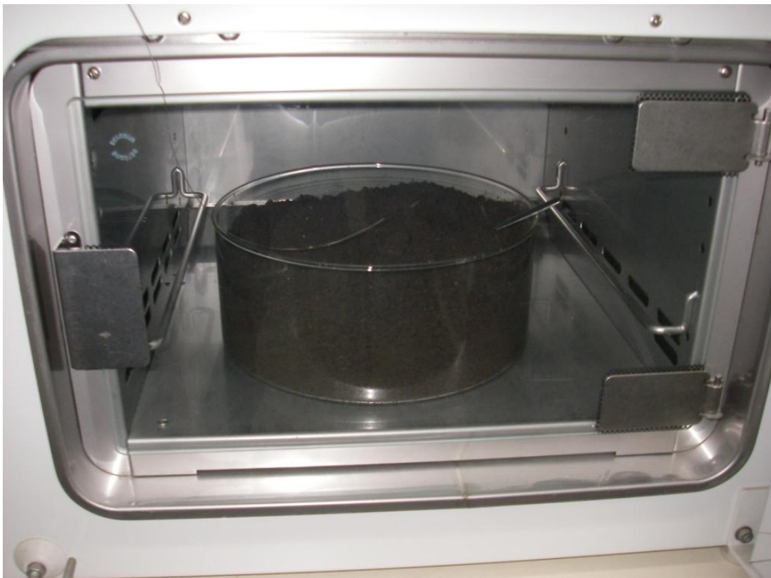
Abb. 2: Entwässerter Klärschlamm in Glasschale im Trocknungssofen
