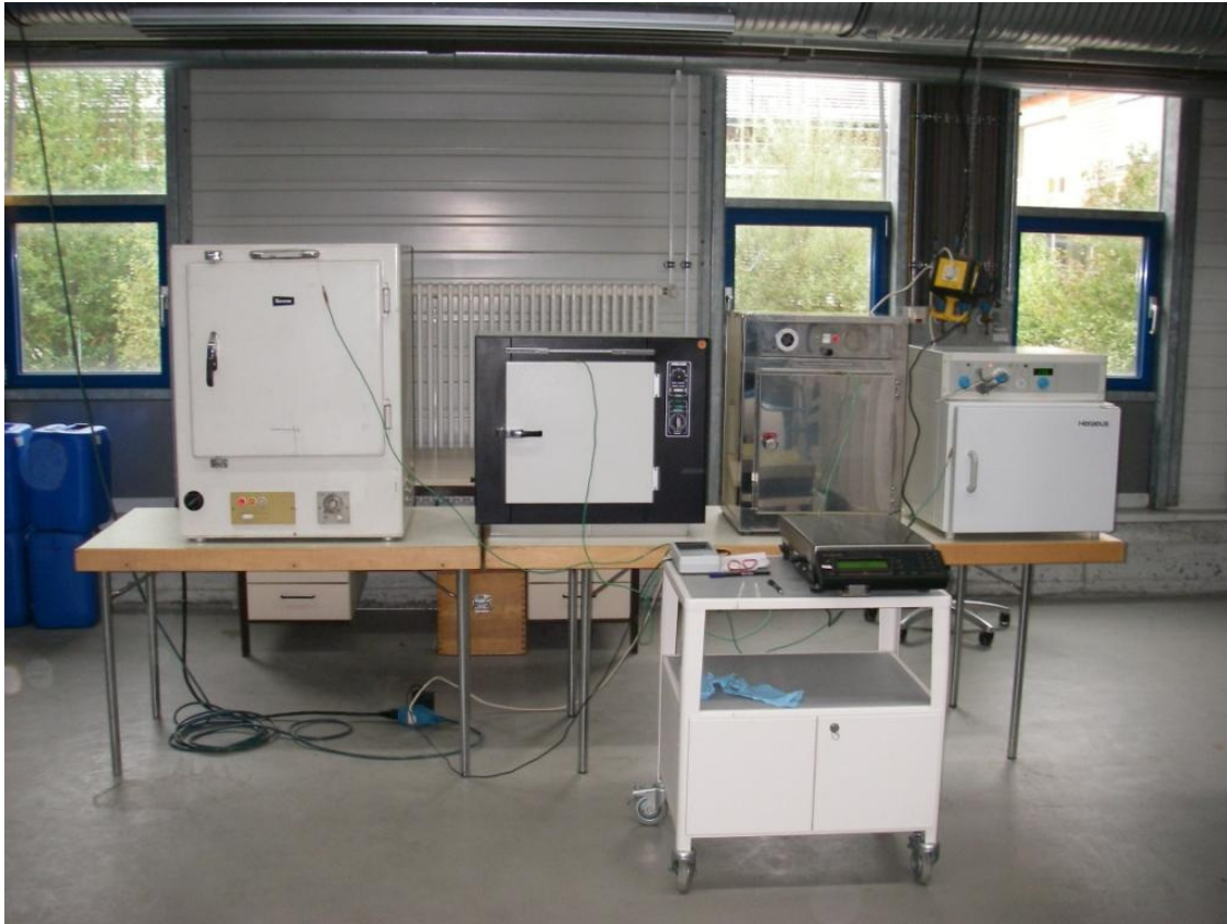
Abb. 1: Aufbau des Trocknungsversuchs mit den vier Trockenöfen
