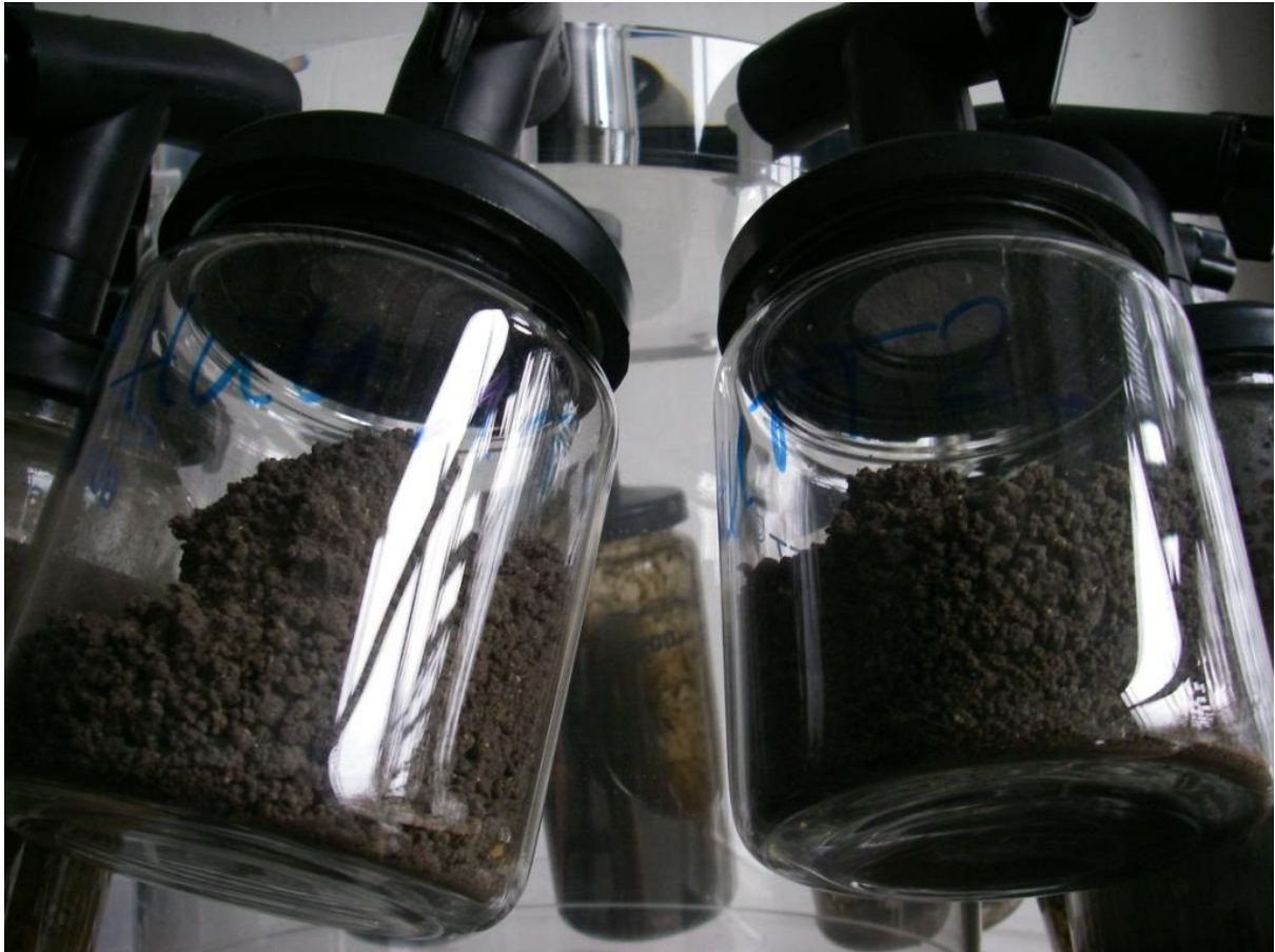
Abb. 3: Gefriertrocknung der entwässerten Vergleichsprobe
