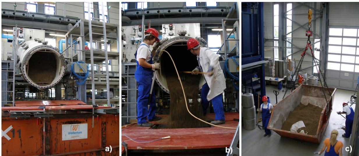
Abb. 23: Rückbau des Festbetts nach Versuchsabschluss, Neigen eines Reaktors (a) zum Entleeren in eine Absetzmulde (b) und Wiegen des Schüttguts zur Wassergehaltsbestimmung (c).
