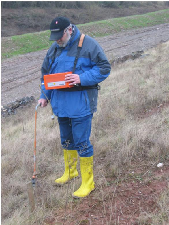
Abb. 1: FID- Messung an der Deponieoberfläche
