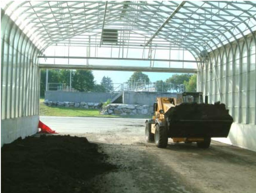
Abb. 3: Befüllung der Anlage mittels Radlader
