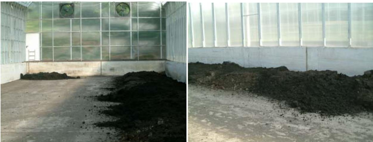
Abb. 4 + 5: Schlammverteilung im Innern der Trocknungsanlage
