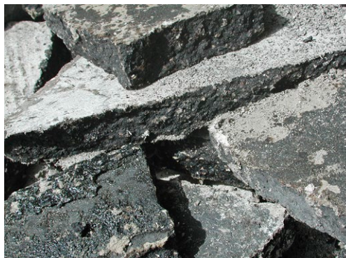
Oben rechts: Teerhaltige Schwarzdecke auf teerhaltig vorgespritzter Schottertrag- schicht
