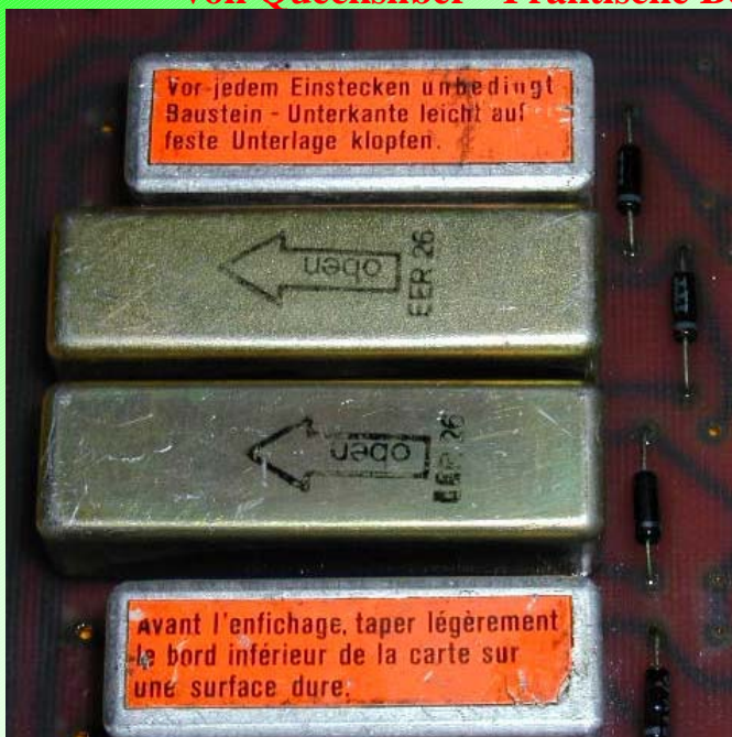
EDV-Board Beispiel 2 Quecksilberschalter ohne Kennzeichnung
