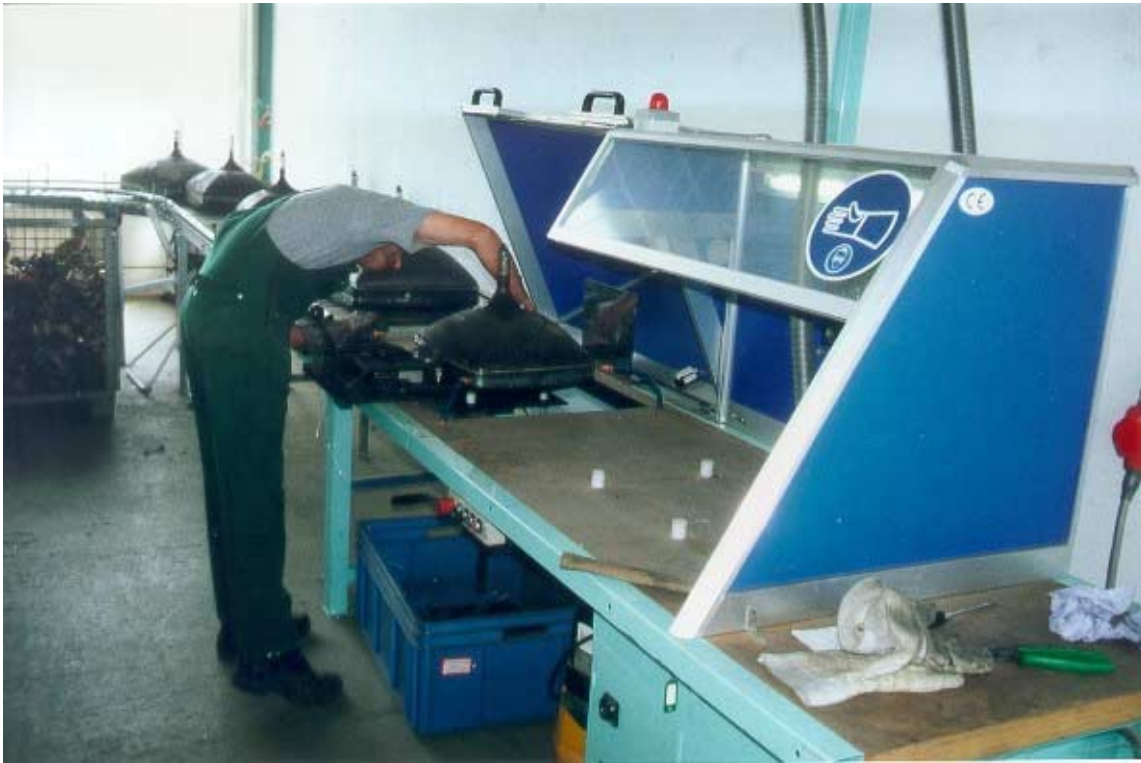
Abbildung 6.3: Bildröhrentrennung mittels Spanndrahtverfahren (Firma EHG Wallner Recycling GmbH, Chieming)
