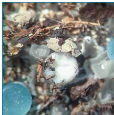
Selbst erstellte Prüfkörper in der größeren Siebfraction
