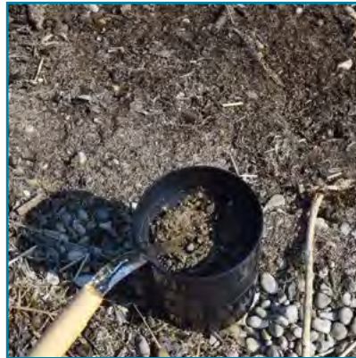
Die Probe wird in einem Siebsatz gewaschen.
