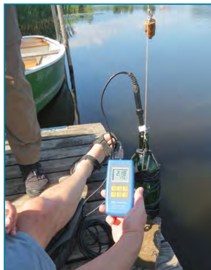
Mit der Sauerstoff-Elektrode wird der Sauerstoff-Gehalt gemessen.
