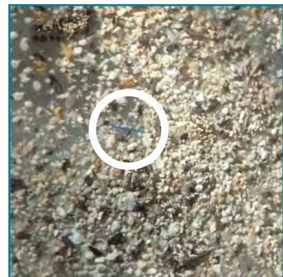
Eine blaue Faser Mikroplastik in der kleineren Fraktion
