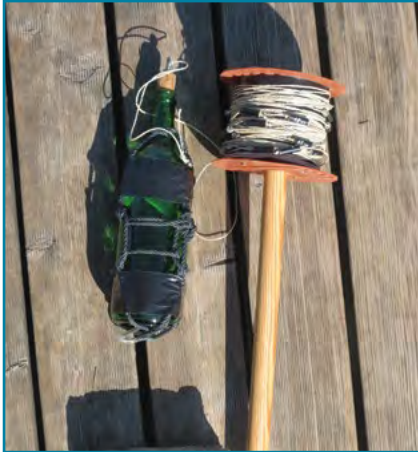
Probenflasche, Leine mit Längenmaß, Gewicht
