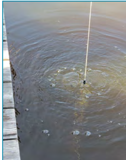
Durch einen Ruck an der Leine geht der Stopfen aus der Flasche und die Luft darin entweicht.
