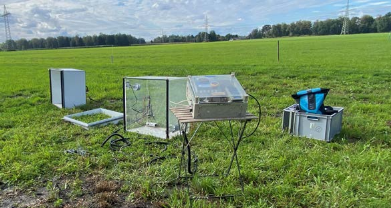
Abbildung 2: Versuchsaufbau der Hochschule Weihenstephan-Triesdorf für Treibhausgasmessungen mit der sogenannten Haubentechnik (Foto: Dr. Theresa Anna Lehmail).
