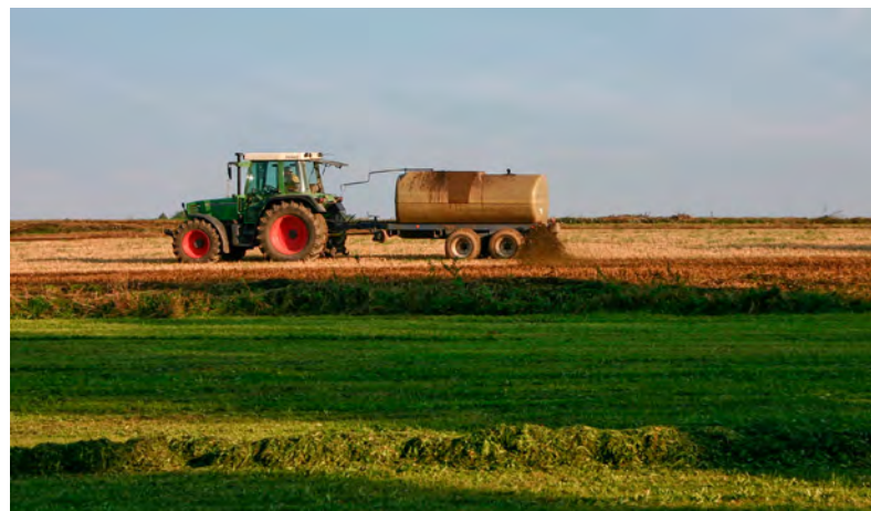
Abb. 3: Die neue Düngeverordnung (DüV) soll insbesondere die Stickstoff- und Phosphat-Belastungen der Grund- und Oberflächengewässer reduzieren. Nicht auf den Boden gerichtete Ausbringungstechniken von Gülle wie in diesem Beispiel sind nach dem Referentenentwurf nur bis zu einem Abstand von 4 m zum Böschungsrand von Gewässern erlaubt (Foto: Karl-Heinz Altmann/Piclease).
