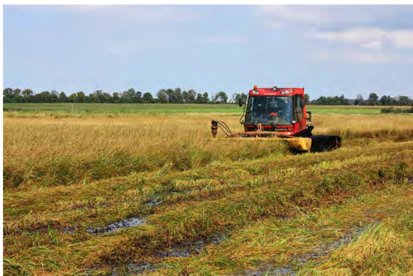
Abb. 2: Mit Spezialgerät – einem umgebauten Pistenbully – ist auch die Mahd einer nassen Seggenwiese möglich (Foto: Christian Schröder).
