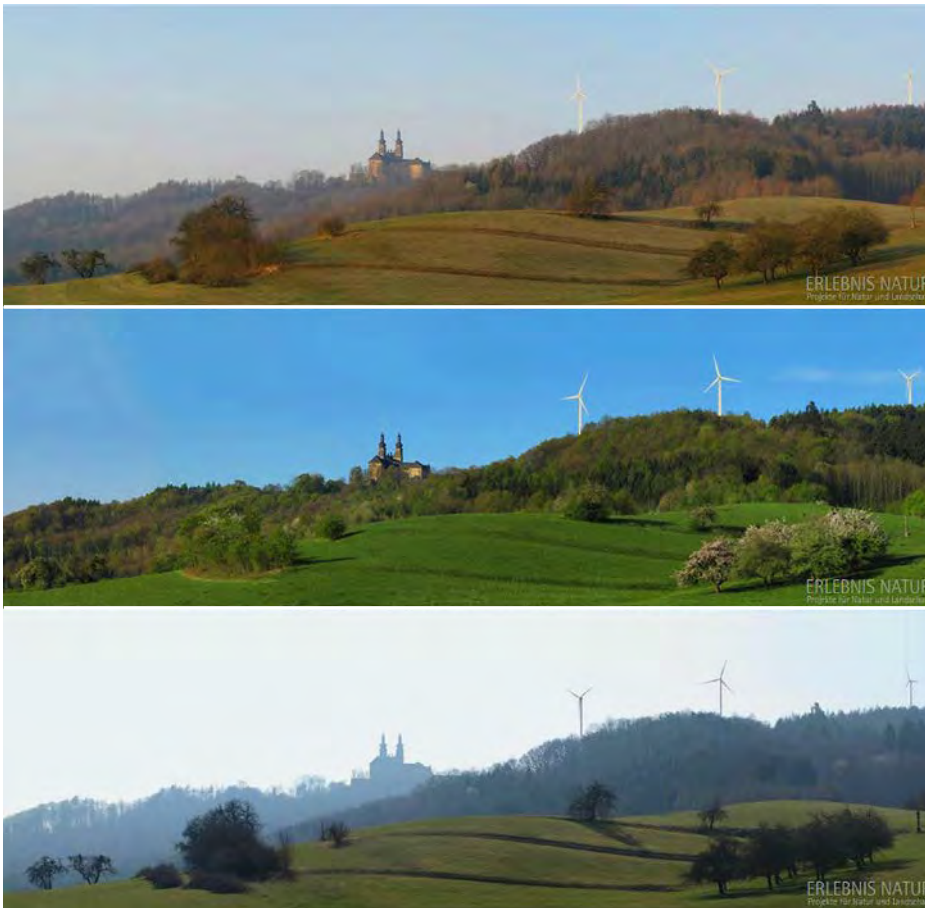
Abb. 4: Beispiel für eine virtuelle 3D-Konstruktion von Windkraftträdern in Kombination mit Landschaftsfotografie zur Analyse der Fernwirkung von Windrädern je nach Tageszeit der Aufnahme. Die Windräder wurden animiert und simulieren so die Wahrnehmung der Anlagen durch den Betrachter realistischer.
