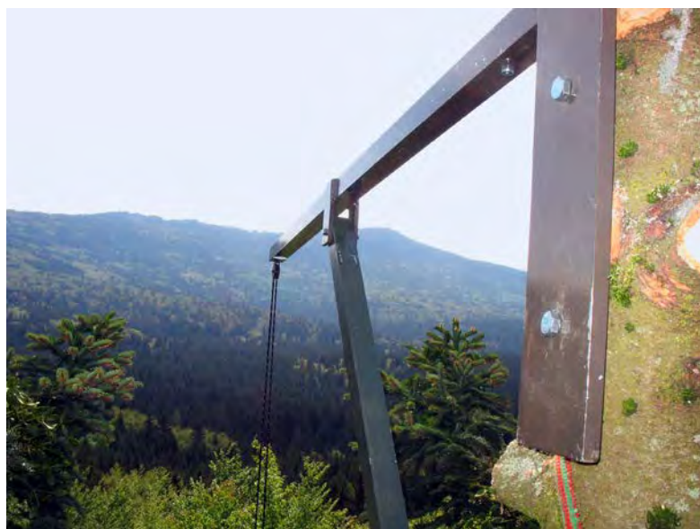
Abb. 1: Blick in den freien Luftraum aus der Krone einer Altanne heraus. An den Stamm ist ein Metallwinkel angeschraubt. Auf diese Weise lassen sich bequem Batcorder in verschiedenen Höhen vom Waldboden bis über das Kronendach ausbringen.
