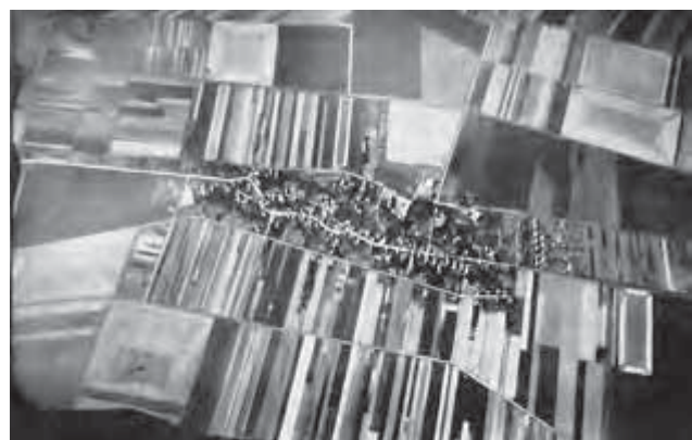
Abbildung 4: „Steilaufnahmen dagegen haben eine Aufnahmerichtung, die nur mäßig gegen ein gedachtes Lot abweicht. (...) Die Schrägaufnahme liegt in dem Raum zwischen Flachaufnahme und der Steilaufnahme“ (FISCHER 1938, 17).
