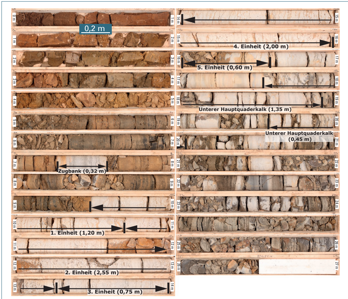
Abb. 27: Stratigraphische Einteilung der Kernbohrung Ki 25 (E 32 562.987:N 5.494.683). Die erbohrte Abfolge umfasst 0,4 m Quartär, 6,4 m Horizonte des Keupers und 19,7 m des Oberen Muschelkalks 3. Die potenziell rohstoffhöffigen Bereiche liegen zwischen 9,50 m und 16,60 m.
