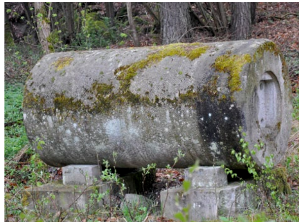
„Vergessene“ Schleifwalze in einem Steinbruch im Ebelsbachtal: Schleifwalzen aus Coburger Sandstein wurden unter anderem auch in die Karibik exportiert.
