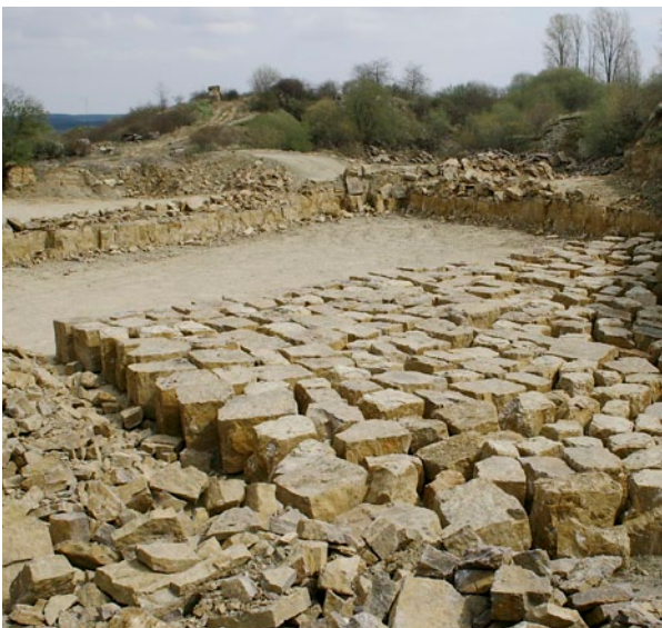
Quaderkalkblöcke in einem Steinbruch bei Winterhausen – bereit für die Abholung.
