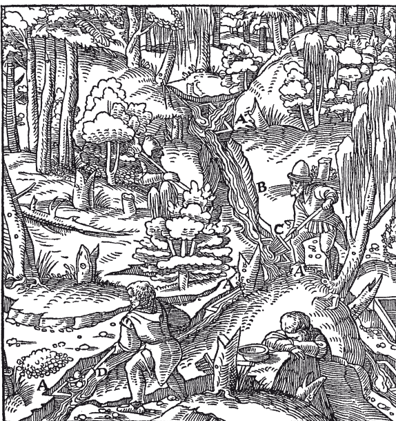
Die Tröge A. Der Gießbach B. Die Seifengabel C. Die Schaufel D.
