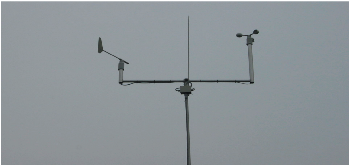
Abb. 3: Windrichtungs- (links) und Windgeschwindigkeitsgeber (rechts).
