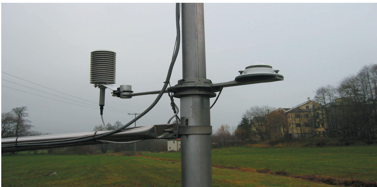
Abb. 4: Luftfeuchtesensor (links) und Sternpyranometer (rechts).
