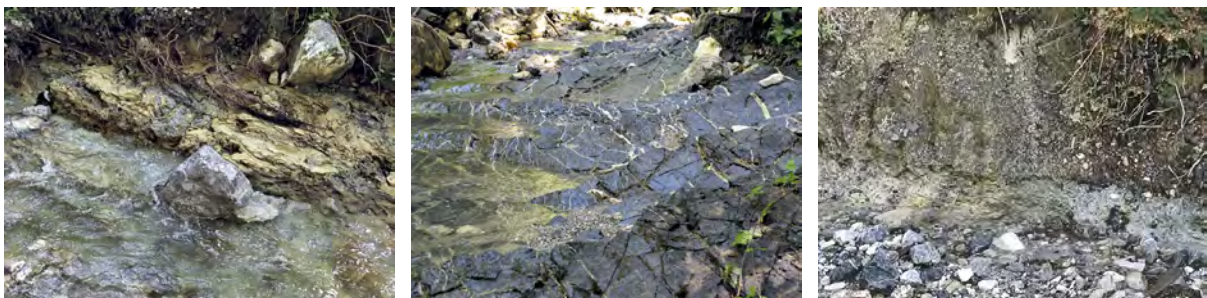
Abb. 2-5: Aufschlüsse der Reichenhall Formation im Rachelgraben (Reit i. Winkl); Links: gelbliche Rauhwaacke; Mitte: dunkler, von Calcitadern durchzogener bituminöser Kalkstein; Rechts: haselgebirgsartige Ausbildung
