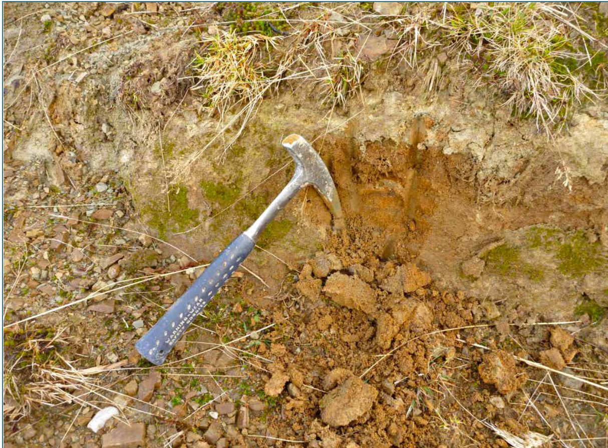
Abb. 17: Vollständig zersetzte, sandig zerfallende Kalksandsteine der Altlangbach-Formation nordöstlich des Hinteren Hörnle (1.503 m ü. NN)
