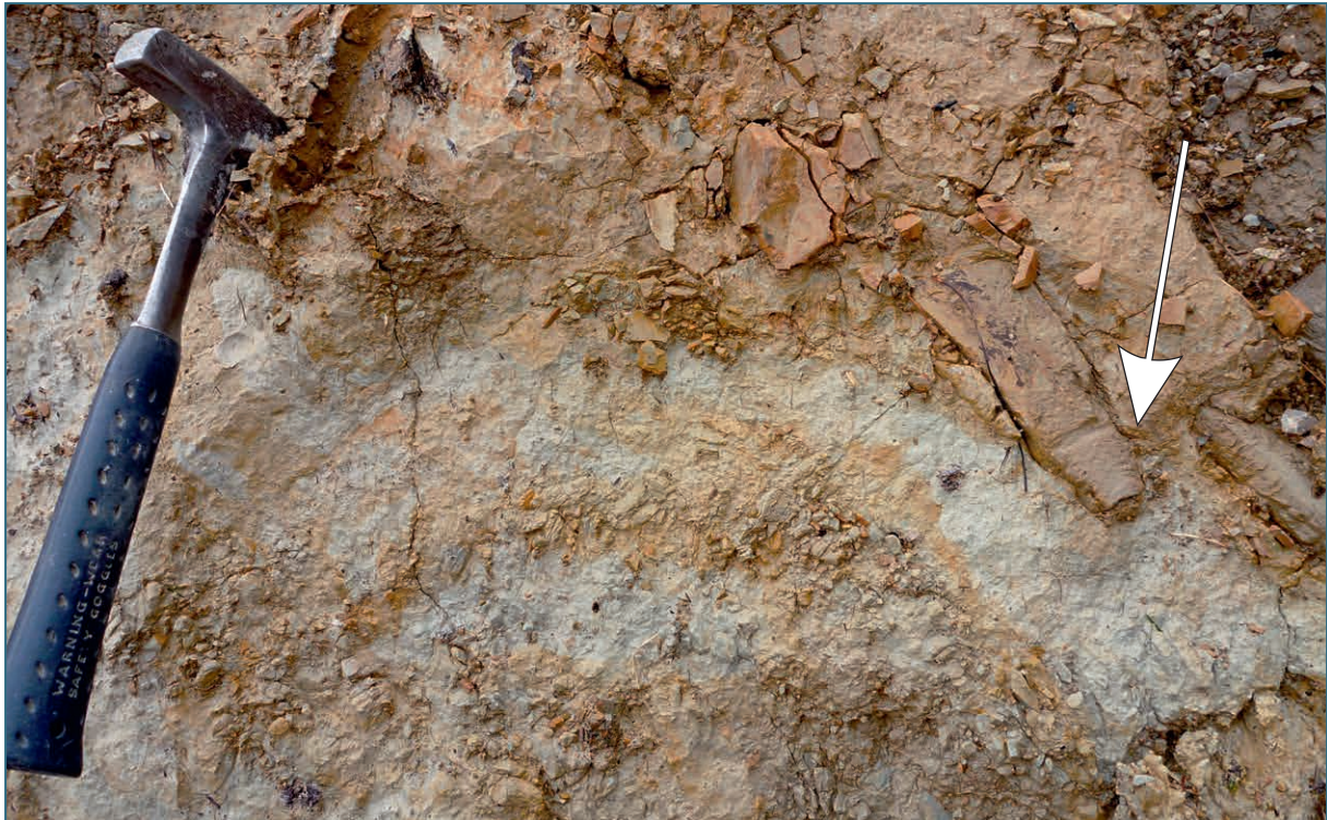
Abb. 11: Detailaufnahme des schlierigen, weißgrau-orangen Lehms zwischen hellgrauen, zersetzten Mergelsteinen (unten) und hellocker Diamikt (oben). Plattige Steine sind hangabwärts eingeregelt und spießen in den weißlichen Lehm.
