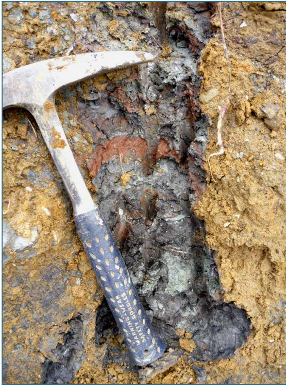
Abb. 6: Lehmig verwitterte schwarze, rote und grau-grüne Tonsteine der Lahnegraben-Formation, die unter 5 m mächtigen, karbonatischen Moränenablagerungen aufgeschlossen sind
