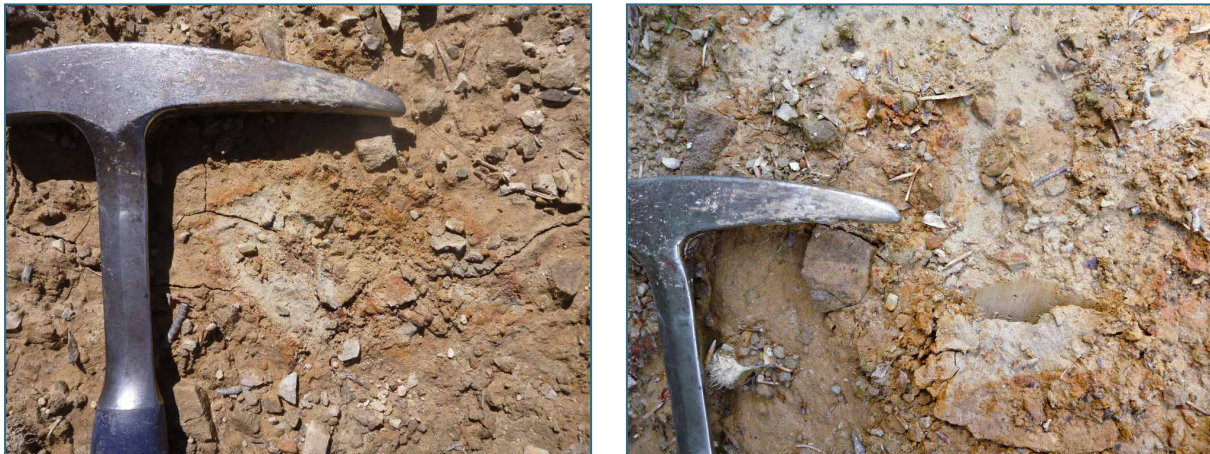
Abb. 20/21: Im Weg zur Auerhahn-Diensthütte (R: 4431700, H: 5277060), NE Rehbrenkopf, sind auf 1.208 m ü. NN in orangeocker, karbonatfreiem, kiesigem Lehm 5 bis 30 cm große, kantige Komponenten aus weißgrauem, karbonatfreiem, feinsandigem Schluff aufgeschlossen. Die Grenzen sind scharf mit einem 5 bis 10 mm mächtigen Saum aus rotocker, karbonatfreiem Lehm.
