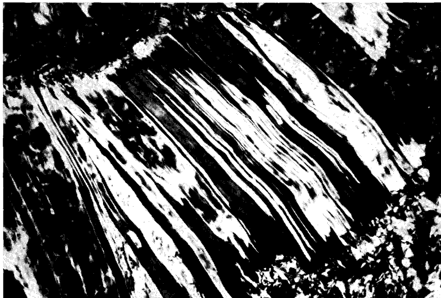
Abb. 3. Parallelverwachsung von Phlogopit (hell) und Mg-Chlorit (dunkel) in ultramafischem Gestein. Bohrkern 826,3 m der Bohrung Nördlingen 1973, Schl. Nr. x429 (BGLA), Vergrößerung 250x.
