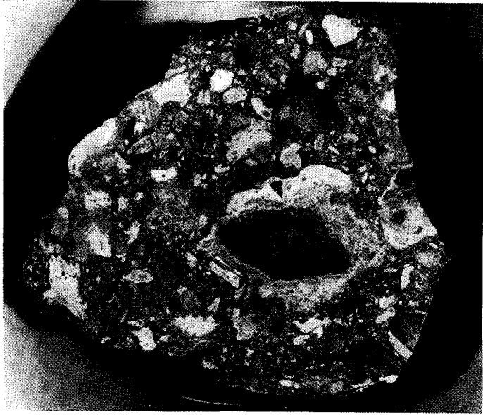
Abb. 2. Breccie von Chassenon. Geschnittene Platte, zeigt verschiedene Einschlüsse und glasige Partien in der kompakten Grundmasse. Gut erkennbar ein rhombenförmig angeschnittenes Gneisfragment, von Glas mit Fluidaltextur umgeben. Verkleinert 2 ×.
