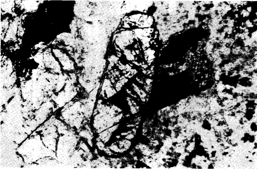
Abb. 10. „Spaltbarkeit im Apatit“. Flasergranit aus der Explosionsbreccie 1 km östlich Lierheim, Blatt Deiningen 7129. Schliff 7542, Vergr. 200-fach, 1 Nicol.
