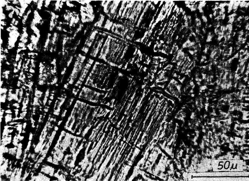
Abb. 20. Planare Elemente nach (010) in Sillimanit. Aus einem Gneis-Einschluß im Suevit von Aumühle (S 768).
