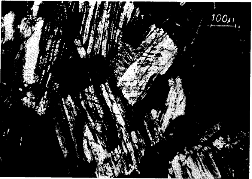
Abb. 18. Deformationsstrukturen in Hornblende. Aus einem Gneis-Einschluß im Suevit von Otting (S 159), gekreuzte Polarisatoren.
