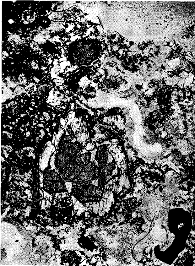
Abb. 16. Glasiges, basaltisches Bröckchen mit Einsprengling von monoklinem Pyroxen mit reliktschem Kern von rhombischem Pyroxen. Vergr. 42 x, + Nic. Schlottuff aus dem Strütt, südöstlich von Kleinostheim.
