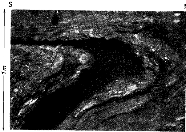
Abb. 2. Ortsbrust einer Strecke im mittleren Graphitzug „Ranna“. Starke Faltung im Gneis bis zu örtlich horizontaler Lage von „s“. Das Graphitflöz (schwarz) war in dem Ortsbrust 5–10 cm tief herausgeschrämt.
