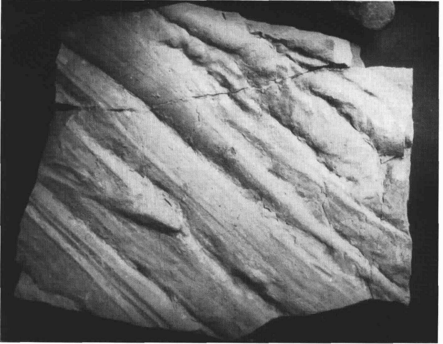
Fig.7. Größerer Typ von Schleifmarken (drag marks, groove casts i. e. S.). Es bilden sich bereits kleine Auskolkungen des Liegenden, die eine Ermittlung der Strömungsrichtung möglich machen (hier von unten rechts nach oben links). Die zopfartigen Schleifmarken rechts oben gehen wahrscheinlich auf eine etwas turbulente Strömung zurück. Alter Grauwackebbruch Welitsch (Blatt Sonneberg), Größe des Stückes 27 \times 22 cm, Foto K. Wehrle 1964.
