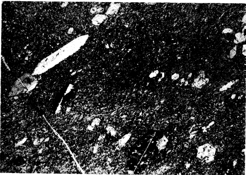
Fig. 2. Vergr. 12-fach — Nic. + — Hornblendenadel-Dioritporphyrit — Stbr. Nr. 30 — Schliffnr. 2060/1. Frische, geregelte Hornblendenadeln in chloritisierter, kryptokristalliner Grundmasse.
