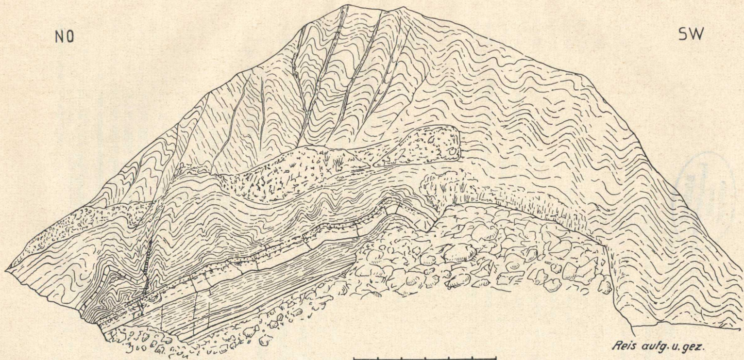
Querschnitt durch einen Steinbruch mit Wellenkalk (Oolithbank) SO. von Stralsbach
