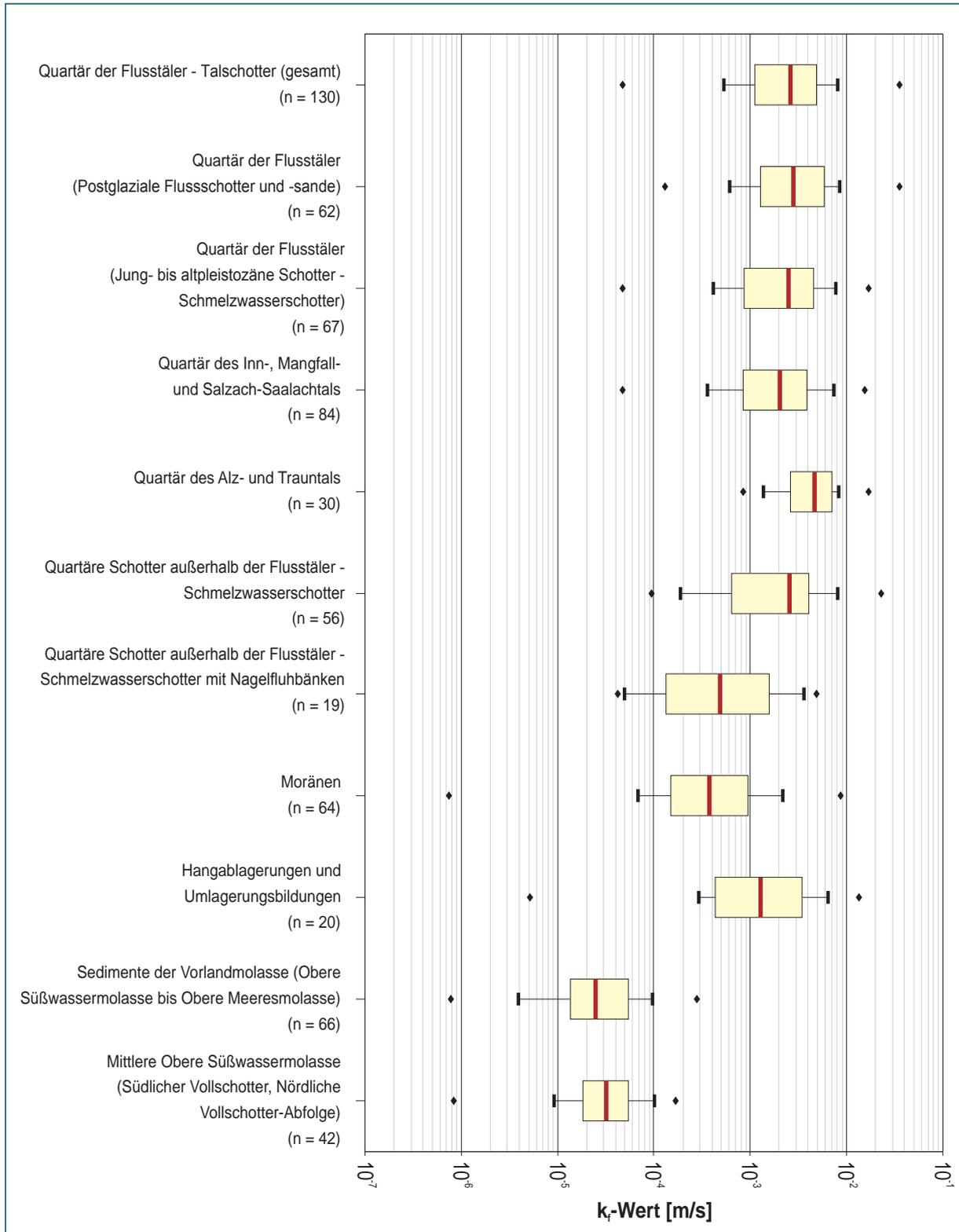
Abb. 3-2: Spannweitendiagramme der ermittelten Durchlässigkeitsbeiwerte ( $k_f$ -Werte) in der Planungsregion 18 Südoberbayern, differenziert nach hydrogeologischen Einheiten
