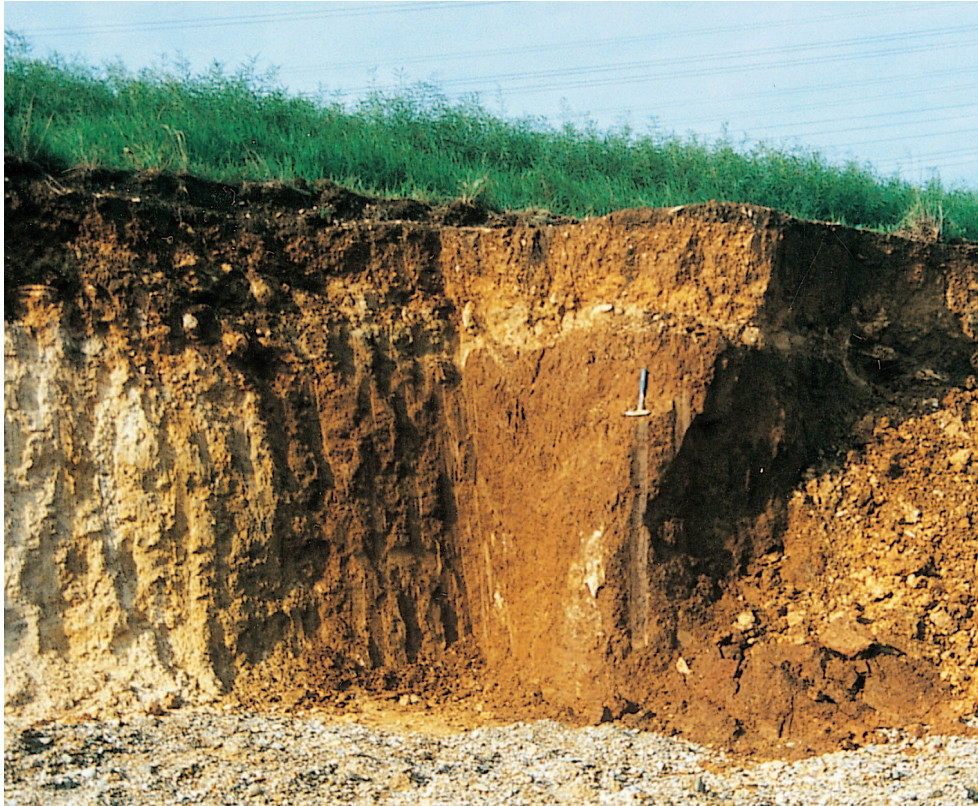
Abb. 3-29. Baugrubenaufschluß im Ablehm in Böhmfeld [7134GP0176]. – Auf dem Foto ist eine Karstspalte in tiefgründig verwitterten Platten- und Bankkalken der Reisbergsschichten (Malm Zeta 3) zu sehen. Die Karstspalte ist verfüllt mit löblehmführendem Ablehm. Karstspalte und Reisbergsschichten sind von einer gelbbraunen und einer braungelben Fließerde und humosem Oberboden überdeckt.
