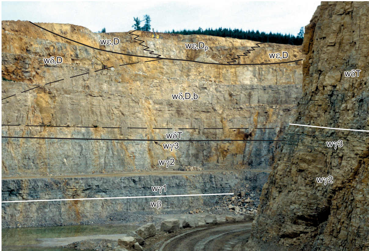
Abb. 3-3. Großer Steinbruch der Fa. Geiger W Pfraundorf [6934AG0009]. – Die über 100 m hohe Bruchwand erschließt über den Werkkalken des Malm Beta ( w\beta ) die Bankkalken des Malm Gamma ( w\gamma ) mit den Platynotamergeln ( w\gamma 1 ) an der Basis und den Crussoliensismergeln ( w\gamma 3 ) im Dach. Darauf folgen im Malm Delta die Dickbänke des Treuchtlinger Marmors ( w\delta T ), die in der Bruchwand im Vordergrund rechts mächtiger als in der hohen Wand im Hintergrund anstehen. Über dem Treuchtlinger Marmor entwickeln sich mehr als 50 m bräunlich verwitterte Tafelbankige Dolomite des Malm Delta ( w\delta, D, b ), die nach links in ungegliederte Riffdolomite ( w\delta, D ) übergehen. Im höchsten Teil des Bruches schalten sich in Riffdolomite des Malm Epsilon ( w\epsilon, D ) feingeschichtete Plattendolomite ( w\epsilon, D_p ) mit Kieselplatten und Kieselknollen ein.
