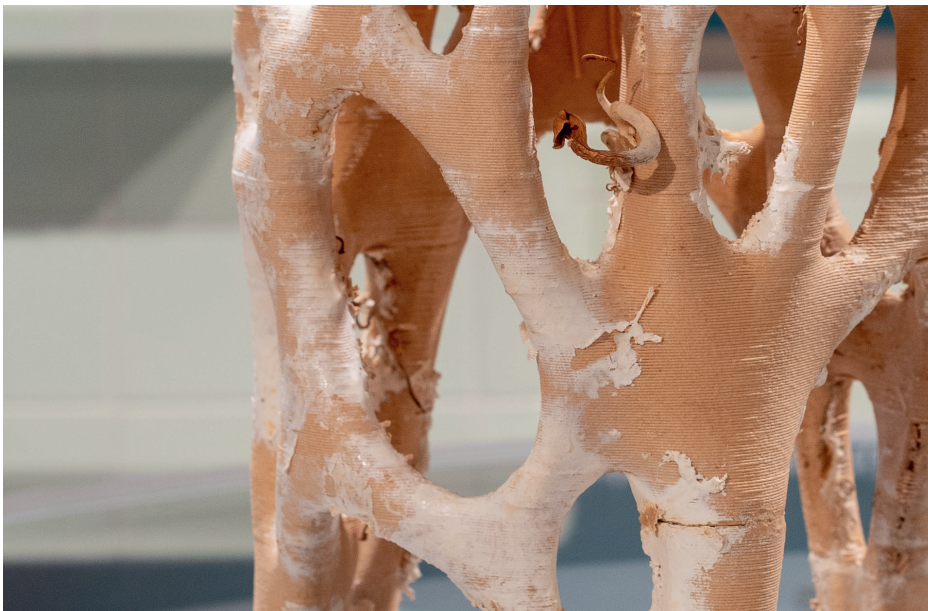
Detailaufnahme eines Hockers, der mit lebendem Myzel (Zellfäden von Pilzen) im 3D-Druck hergestellt wurde.
