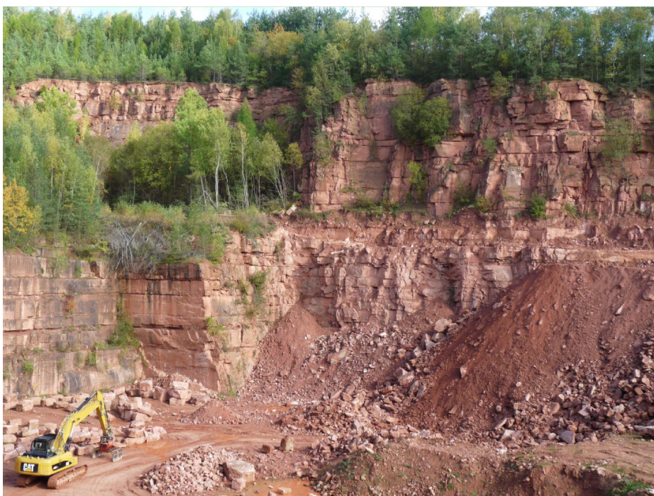
Abb. 10: Blick auf die östliche Wand des Steinbruchs Theresienhof im Miltenberger Sandstein; oberhalb der Berme mit Strauch- bis Baumbewuchs der Basis-Sandstein der Bernburg-Formation mit bis 3 m dicken Bänken (über der obersten Steinbruchkante wurde auch Tonlagen-Sandstein abgetragen), darunter der Dickbank-Sandstein der Calvörde-Formation mit an der Basis bis 4 m mächtigen Bänken. Die Schichten fallen nach rechts (SE) ein.
