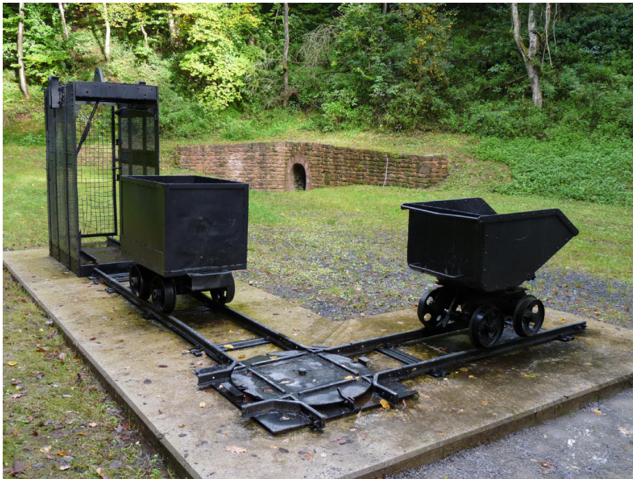
Abb. 26: Restauriertes Mundloch des ersten Förderstollens aus dem Jahr 1786, zwei Förderhunte und der Förderkorb am Rastplatz für Wanderer jenseits der Straßengabel der Kreisstraßen MIL 2 und MIL 28
