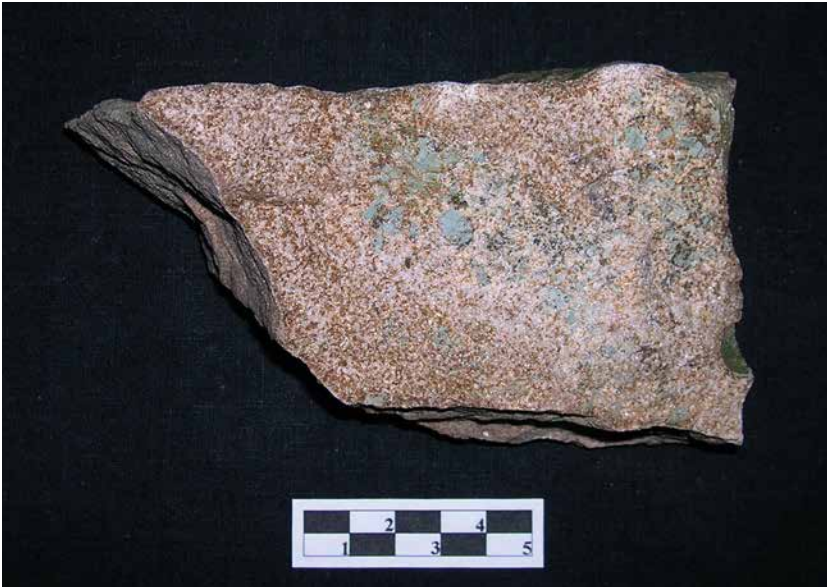
Abb. 20: Lesestein aus dem Blasensandstein i. e. S., oberer Bereich mit typischer Tonsteingallenführung, SW Bühl, Maßstab in Zentimeter
