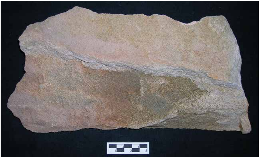
Abb. 21: Handstück aus dem Coburger Sandstein mit den typischen, glimmerreichen Schichtflächen und grünen Tonsteinhäutchen (Unterer Werkstein, S Kottenbrunn), Maßstab in Zentimeter
