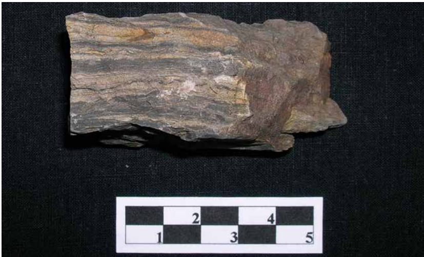
Abb. 15: Dünnsschichtige Tonstein-Schluffstein-Wechsel aus dem Übergangsbereich des Schilfsandsteins zu den hangenden Lehrbergschichten aus dem Umfeld zwischen Königsberg i. Bay. und Altershausen, Maßstab in Zentimeter
