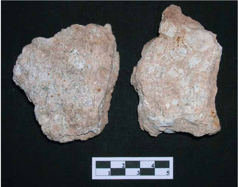
Abb. 27: Lesesteine aus dem Mittleren Buntsandstein zwischen Zeil und Bischofsheim mit typischer rötlich-weißgrauer Färbung und Führung von dolomitischen Knauern, Maßstab in Zentimeter
